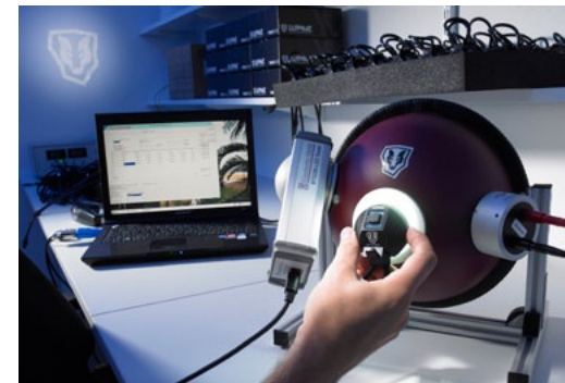
Messung der Lichtleistung
